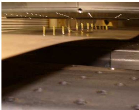
Bild 2: Versuchsstand eines Schwebedüsenfeldes
