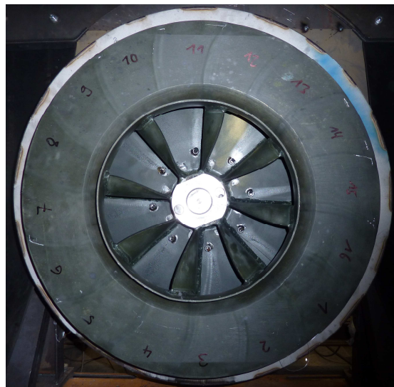
Bild 1: Testrotor eines Heißgasventilatorlaufrades auf dem Prüfstand
